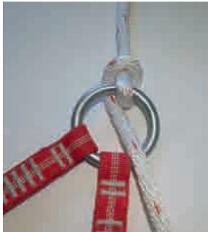
**Abbildung 50:** Seilverlauf Halbmastwurfsicherung Anschlagring IRS
