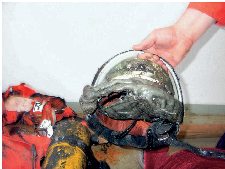
Abb. 5.1.3.2/2: Zerstörter Feuerwehr- helm mit Gesichtsschutz
