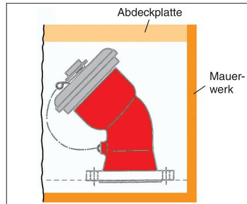
Abb. 4.4.5.6/15: Löschwasser-Sauganschluss, Unterflur
