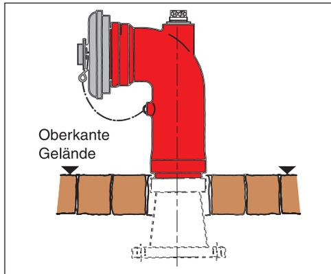
Abb. 4.4.5.6/14: Löschwasser-Sauganschluss, Überflur
