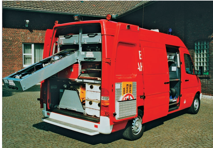
Abb. 7.4.7/5: Heckansicht eines Gerätewagens Gefahrgut GW-G 1 (Quelle: Heines, Haan)
