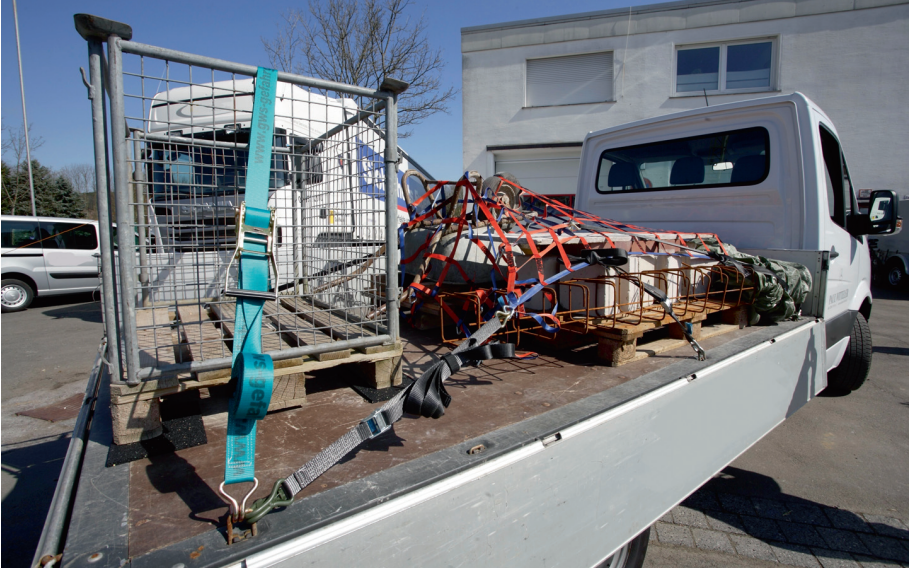
Bild 8.4: Auch Leerpaletten müssen gesichert werden. Die Gitterboxpalette steht auf Antirutschmatten und wurde mit einem Zurrurt niedergezurrt. Vorn ist das Baumaterial mit einem Netz gesichert.
