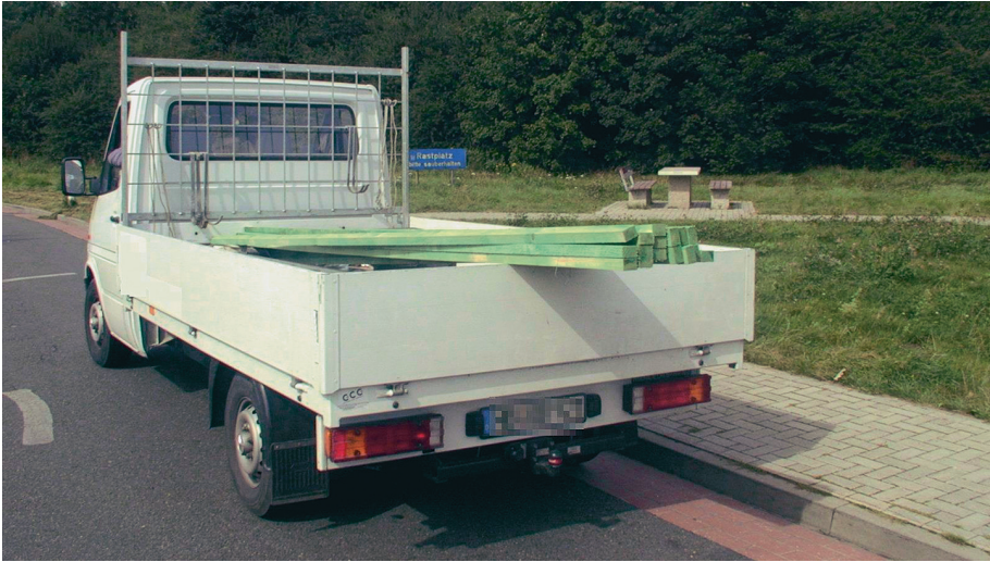
Bild 8.2: Zwei Umspannungen hätten hier gereicht, um die Ladung ausreichend zu sichern.
