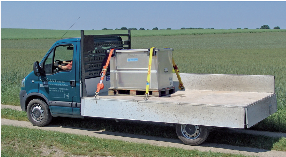
Bild 8.3: Dieser Transportbehälter für Airbagmodule (ohne Formschluss) ist stabil genug, um mit 250 daN niedergezurrt zu werden.
