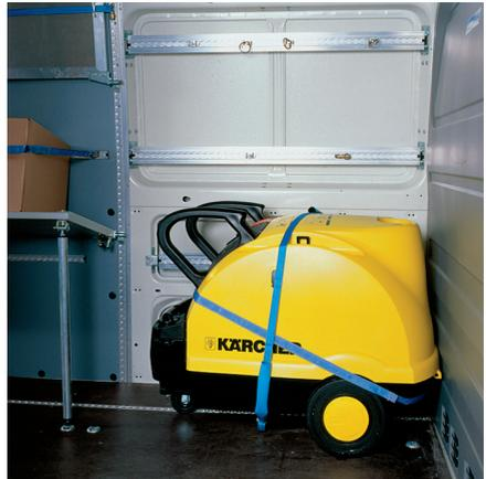
*Bilder 8.42 und 8.43: Diese Innenausrüstung beim Kleintransporter bietet eine Menge an Möglichkeiten, Ladung schnell und gut zu sichern.*
