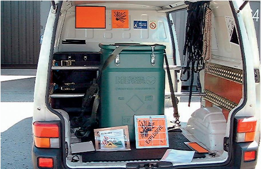
*Bild 8.33: Dieser Kastenwagen bietet genügend Sicherungsmöglichkeiten. Das Fahrzeug hat nach ADR eine EX/II-Zulassung. (Quelle: Bilder 8.33 u. 8.34, J. Bolenius, Bremen)*
