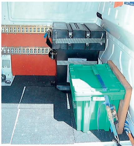
*Bild 8.34: Besser lässt sich ein Fahrzeug zur Ladungssicherung nicht ausrüsten, um allgemeines Ladegut und sogar Gefahrgut sicher zu transportieren.*
