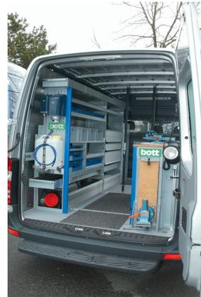
*Bilder 8.37 – 8.39: Spezielle Innenausbauten (z. B. Werkstattausstattung für Sanitär-, Elektriker- oder andere Handwerkerbereiche) sind möglich. Zurrpunkte im Bodenplattenbereich erleichtern ebenfalls die Ladungssicherung. (Quellen: Bilder 8.35 bis 8.38 Sortimo, Bild 8.39 Bott)*
