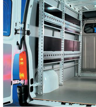
*Bild 8.36: Doppelte Nutzung: Die Unterseiten der Regalböden sind mit integrierten Verzurrleisten versehen.*
