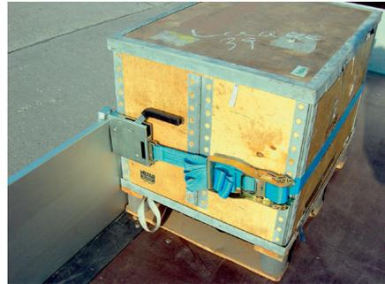
Bilder 8.31 und 8.32: Bordwandanker lassen sich leicht einsetzen und halten das Ladegut zurück.
