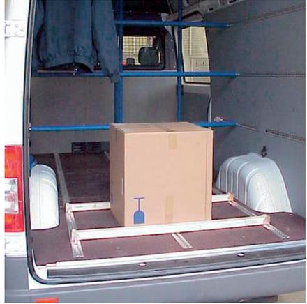
*Bild 8.41: Rückhaltesysteme an Boden- und Seitenschienen. Im Dachbereich sind Vorrichtungen, um Kleidung zu transportieren. (Quellen: IN TIME Direkt-Kuriere und Sortimo)*
