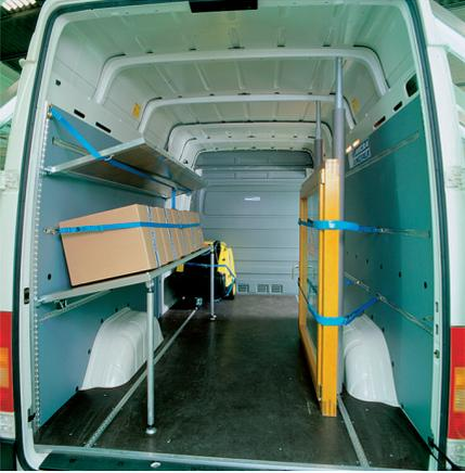
*Bild 8.40: Höhenverstellbare Klappregale sowie Rundsperrbalken als Stütze für Transportgüter, die mit Zurrgurten gesichert werden.*
