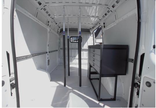
Bilder 8.44 und 8.45: Verschiedene Schienen- und Stangensysteme bieten gute Möglichkeiten der Sicherung.
