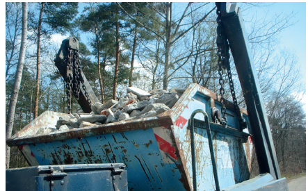
Bild 8.73: Hier ist der Einsatz eines stabilen Netzes zum Abdecken der Ladung erforderlich.
