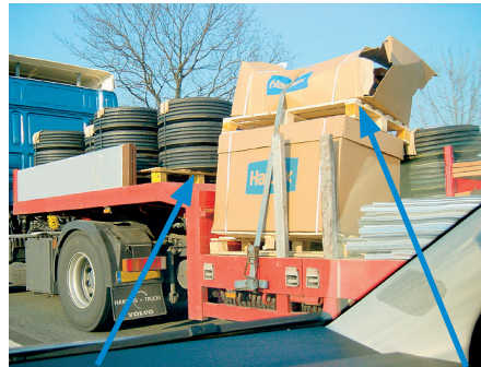
Bilder 8.79a und b: Teile der Ladung sind gar nicht gesichert, andere wurden durch das Niederzurren beschädigt. Als Absender sollte man schon darauf achten, wem man seine Ware anvertraut.
