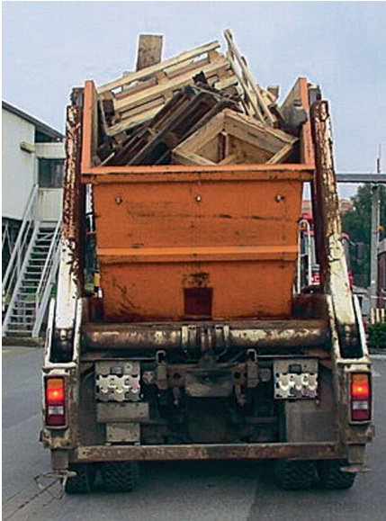
Bild 8.71: Die hoch herausragenden Bretter und Paletten müssen flach gelegt werden.
