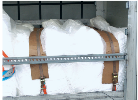
Bild 8.66: Palettierte Big Bags wurden niedergezurrt. Als Kantenschutz und zum Schutz der Bags dient hochfeste Pappe.
