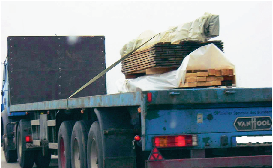
Bild 8.77: Niederzurren mit nur einem Gurt ist leichtsinnig!
