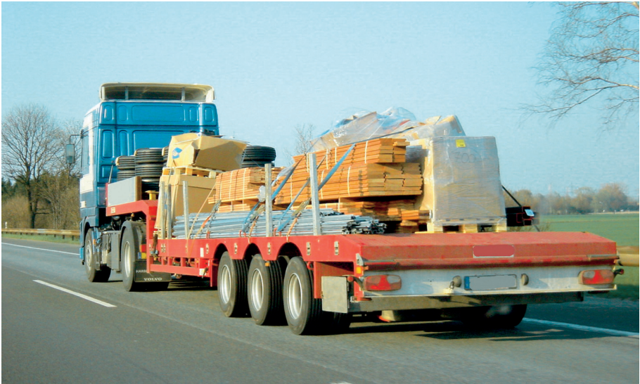
Bild 8.78: Der Kraftfahrer oder der Disponent des Fahrzeugs hat vermutlich nicht über die Sicherung dieser unterschiedlichen Güter nachgedacht.
