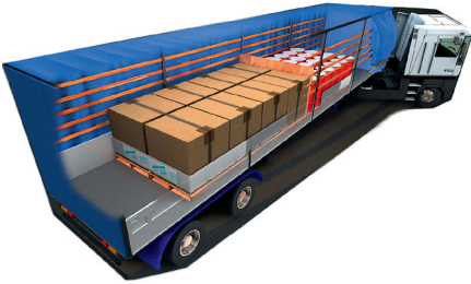
Bild 8.65: Verschiedenste Ladegüter lassen sich mit Road Gard sichern. In Kombination mit Niederzurren kann auf RHM verzichtet werden. (Quelle: Walnut Industries Europa BV)
