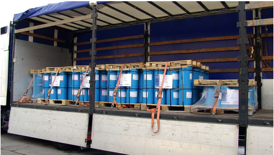
Bild 8.67: Der Einsatz von Paletten ist beim Niederzurren eine Möglichkeit, einen flächigen Anpressdruck zu erreichen.
