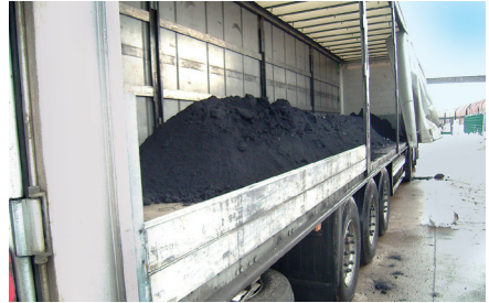
Bild 8.72: So darf lose Schüttung nicht transportiert werden. Der Einsatz von Schüttgutmulden ist notwendig.
