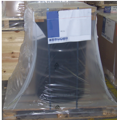
Bild 8.69: Das Fass wurde gebändert und mit Folie zusätzlich geschrumpft.
