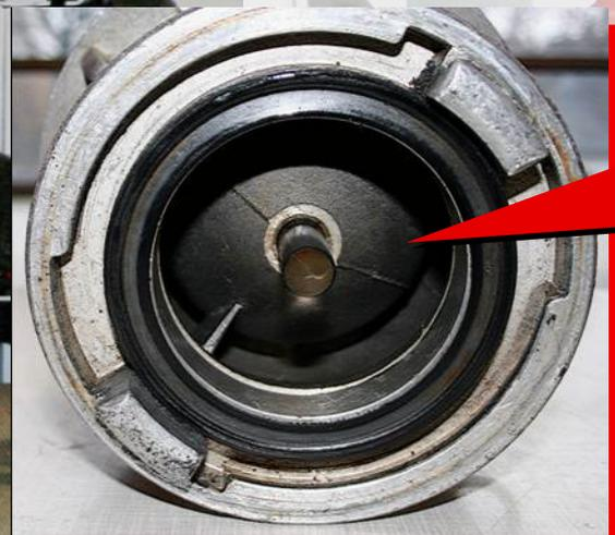
Im Gehäuseinneren befindet sich ein Rückschlagorgan, das sich über eine Öse von außen durch die Ventilleine betätigen lässt.
