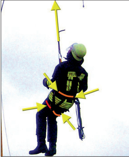
Abbildung 3: Krafteinleitung des Fangstoßes in den Körper bei Verwendung eines Auffang-, Halte- und Sitzgurtes (Quelle: Wertf)
