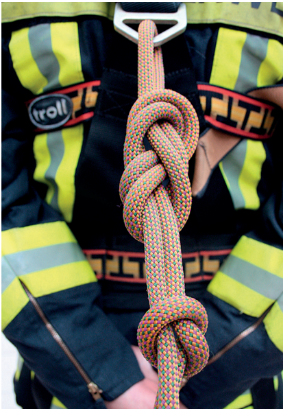
Abbildung 33: Befestigung des Kernmantel-Dynamikseils am Auffanggurt (Quelle: Werft)
