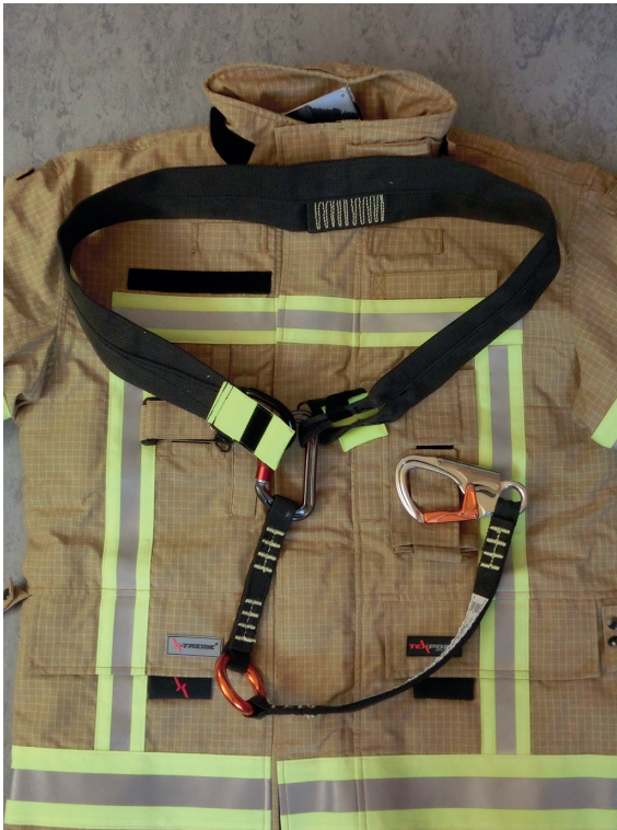
Abbildung 51: Übersicht über ein „Integriertes Rettungssystem“. Der schwarze, 80 mm breite Gurt, eine Kombination aus Rettungsschlaufe und Haltegurt, ist in einem Tunnel in der Jacke eingezogen und ist ebenso wie die Selbstsicherungsschlinge aus Aramidfaser gefertigt. (Quelle: Werft)
