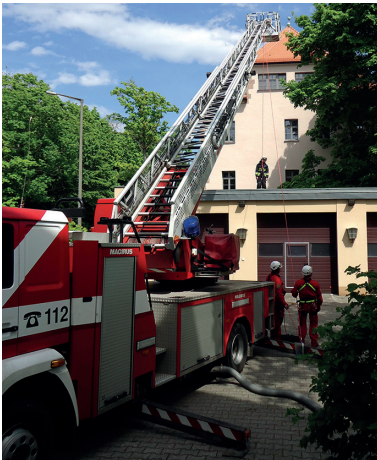
Abbildung 102: Toprope-Sicherung über die Leiterspitze einer Drehleiter. Als Anschlagpunkt für die Seilbremse (HMS) dient in diesem Fall der Stützbalken der DLAK. (Quelle: Werft)
