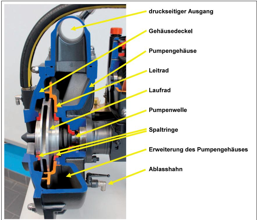
**Abbildung 5:** Schnittmodell einer einstufigen Feuerlöschkreiselpumpe (Quelle: Schlingmann GmbH & Co. KG, Dissen)
