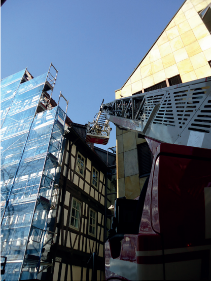
Abbildung 2: Mit einem Leitersatz mit Gelenkarm lassen sich mit dem Rettungskorb auch weit zurückversetzte Dachgauben erreichen. (Quelle: Werft)
