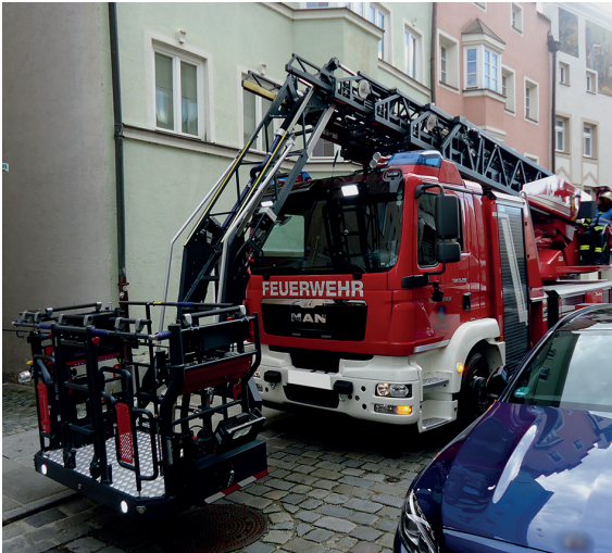
Abbildung 3: Drehleitern mit einem Leitersatz mit Gelenkarm haben einen besonderen Vorteil in engen Straßen und Gassen, der Rettungskorb lässt sich vor dem Fahrerhaus absetzen. (Quelle: Werft)
