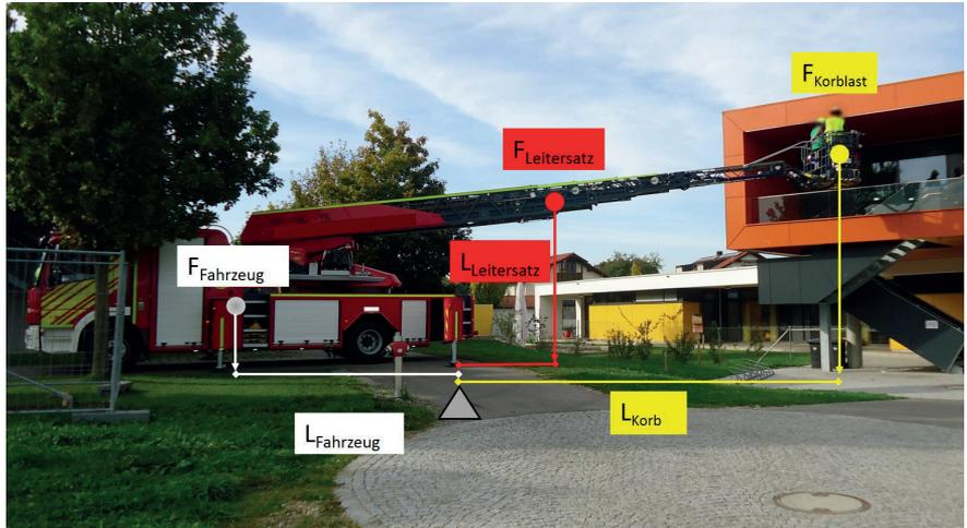
**Abbildung 15:** Schematische Darstellung des zweiseitigen Hebels am Beispiel der Drehleiter vom vorstehenden Bild. Die weißen Beschriftungen (Kraft „F“ und Länge „L“ des Hebelarmes) bezeichnen das Standmoment, die Summe der roten und gelben Beschriftungen (Kräfte „F“ und Länge „L“ der Hebelarme) die der Lastmomente. (Grafik: Werft)
