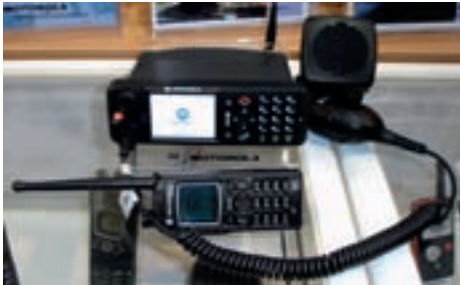
Abb. 1.8.3/1: Handfunkgerät der Firma Motorola vor Fahrzeugfunkgerät mit dem gleichen Bedienkonzept. (Foto: Cimolino)
