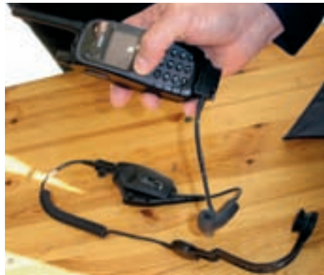
Abb. 1.8.3/2: Handfunkgerät der Firma Sepura im Größenvergleich einer Hand. Beachten Sie, dass die unten am Funkgerät angebaute Helmsprechgarnitur (auf dem Tisch) eine Ladung im Fahrzeug i.d.R. unmöglich macht. (Foto: Cimolino)
