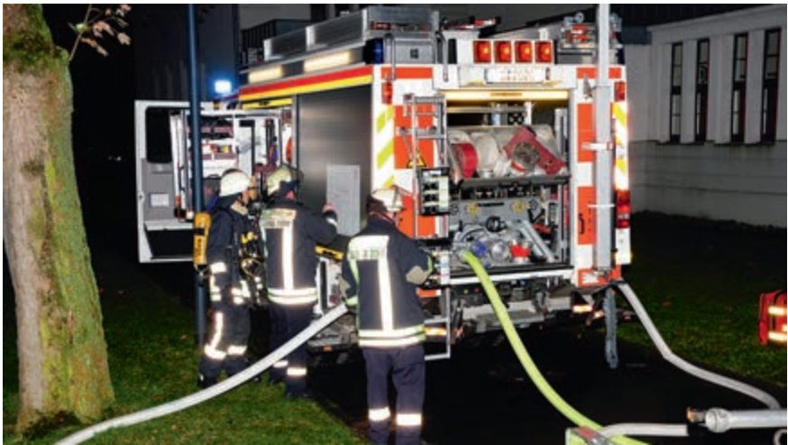
Abb. 7.2/1: Durch die eingeschaltete Umfeldbeleuchtung und die Geräteraumbeleuchtung ist das Löschfahrzeug gut wahrnehmbar. (Foto: Truckenmüller, Düsseldorf)
