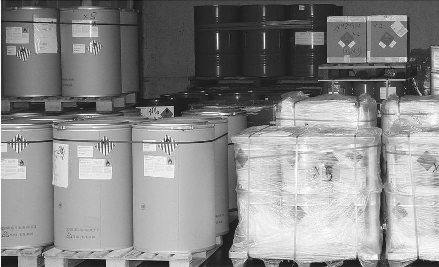
**Foto. I.3:** Die Zusammenlagerung von LGK 3 und 4.1B in Mengen über jeweils 100 kg netto ist gemäß TRGS 510 verboten. Eine Zusammenlagerung ist nur aufgrund geeigneter Brandschutzkonzepte oder der Ergebnisse von Gefährdungsbeurteilungen zulässig.
