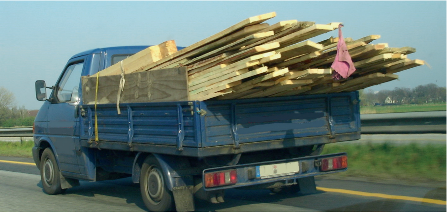
Bild 3.25: Die Grenzen der Lastverteilung sind schnell erreicht. Die weit nach hinten herausragende Ladung sorgt dafür, dass die Vorderräder wenig Bodenhaftung bekommen. Die Absicherung nach hinten mit dem roten Tuch ist ebenfalls nicht zulässig.
