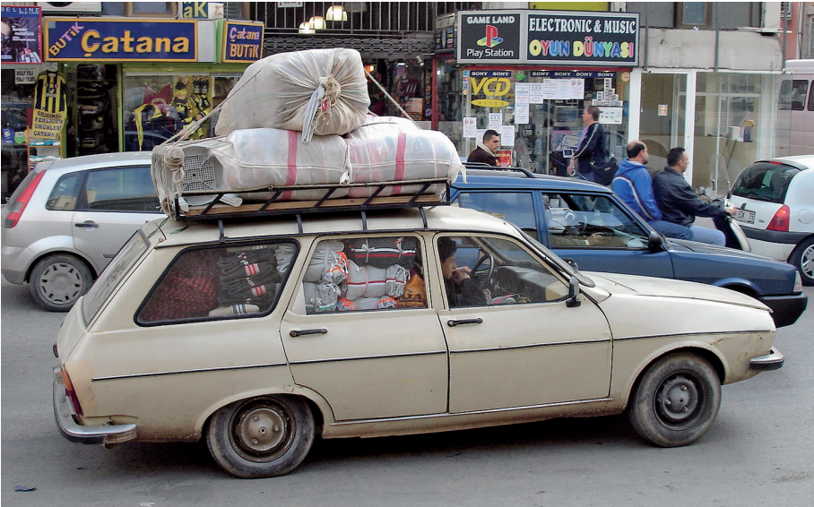
Bild 3.26: Bei diesem Pkw stoßen Zuladung und Lastverteilung bereits hart ans Limit. Durch die Ladung auf dem Dachgepäckträger kommt noch ein hoher Schwerpunkt hinzu. Durch Umklappen der hinteren Sitzbank könnte der Kombi voll ausgeladen werden. Hier jedoch reicht bereits eine geringe Geschwindigkeit, um das Fahrzeug in einer Kurve ins Schleudern zu bringen.
