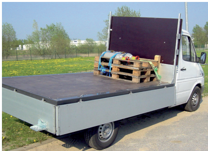
Bilder 8.5 und 8.6: Gasflaschen mit Bündelgurten auf Paletten gesichert, die Gasflaschen auf Antirutschmatten gelegt. Durch Kanthölzer zur Stirnwand wird Formschluss nach vorn erreicht. Der Zurrpunkt kann somit besser genutzt werden.
