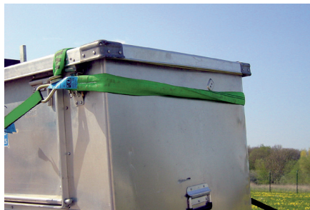
Bild 8.9: Kopflasching mit einer Rundschlinge ist eine sehr effektive Möglichkeit der Ladungssicherung.
