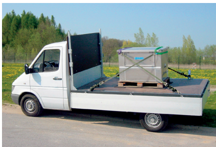
Bild 8.8: Eine weitere Möglichkeit ist das Kopflaschungsverfahren. Hier lassen sich schwerere Transportgüter auch mit kleinen Gurtmaterialien schnell und gut sichern.
