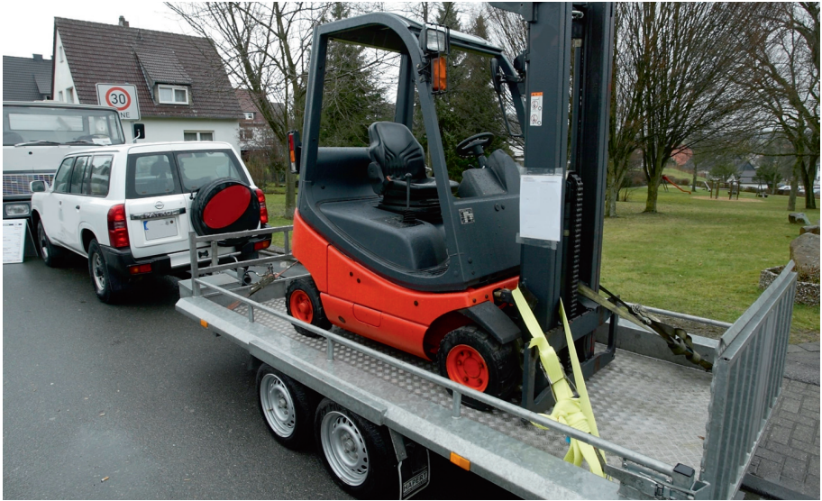
Bild 8.10: Dieser Gabelstapler wurde durch Diagonalzurren gesichert.
