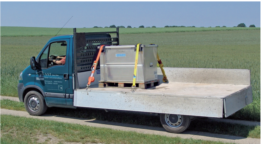
Bild 8.3: Dieser Transportbehälter für Airbagmodule (ohne Formschluss) ist stabil genug, um mit 250 daN niedergezurt zu werden.
