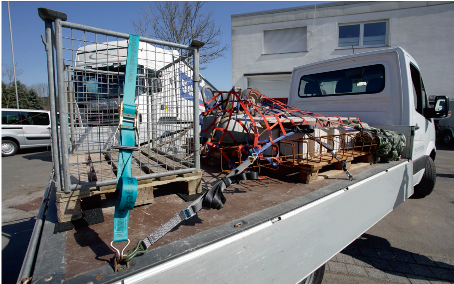
Bild 8.4: Auch Leerpaletten müssen gesichert werden. Die Gitterboxpalette steht auf Antirutschmatten und wurde mit einem Zurrband niedergezurrt. Vorn ist das Baumaterial mit einem Netz gesichert.
