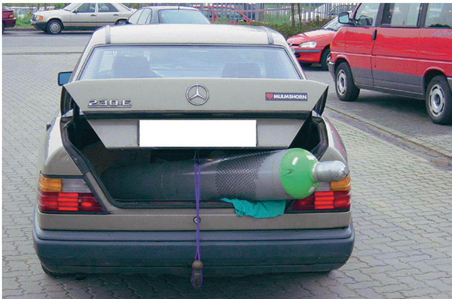
Bild 8.7: Dieses Fahrzeug ist für den Transport von Gasflaschen nicht geeignet . Bei einem evtl. Auffahrunfall besteht die Gefahr, dass das Verschlussventil beschädigt wird und es zu einem großen Schaden kommt. Hinzu kommt, dass ein sicherer Transport von Gasflaschen nach ADR, z. B. 7.5.7.1, so nicht erlaubt ist.
