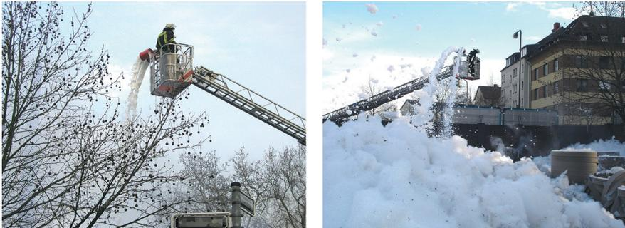
**Abbildung 8a und b:** Mittels eines Aufsatzes mit 2 x M4 für die Werferhalterung der DLK lassen sich auch weiter entfernte oder schwer zugängliche Bereiche einer Einsatzstelle von oben mit Mittelschaum beschäumen. Dies ist v.a. dann günstig, wenn sonst die Wurfweiten der Mittelschaumrohre allein nicht reichen würden. (Quelle: Feuerwehr Düsseldorf)
