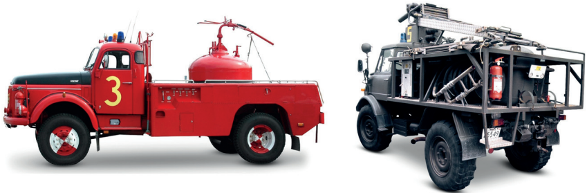
Abbildung 69: Trockenlöschfahrzeuge in ihren typischen frühen Bauformen [90; 91], beachte das „Twin Agent“-Strahlrohr an der PLA des Unimog
