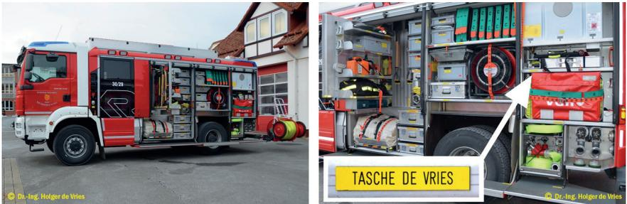
**Abbildung 21:** Gefrästes Schild des Lagerorts
