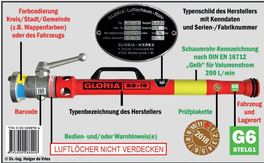
Abbildung 20: (Erweiterte) Gerätekennzeichnung
