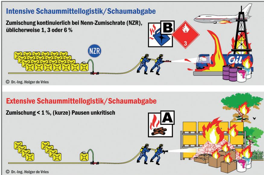
**Abbildung 8:** Zur Definition der intensiven und extensiven Schaummittelversorgung/Schaumabgabe
