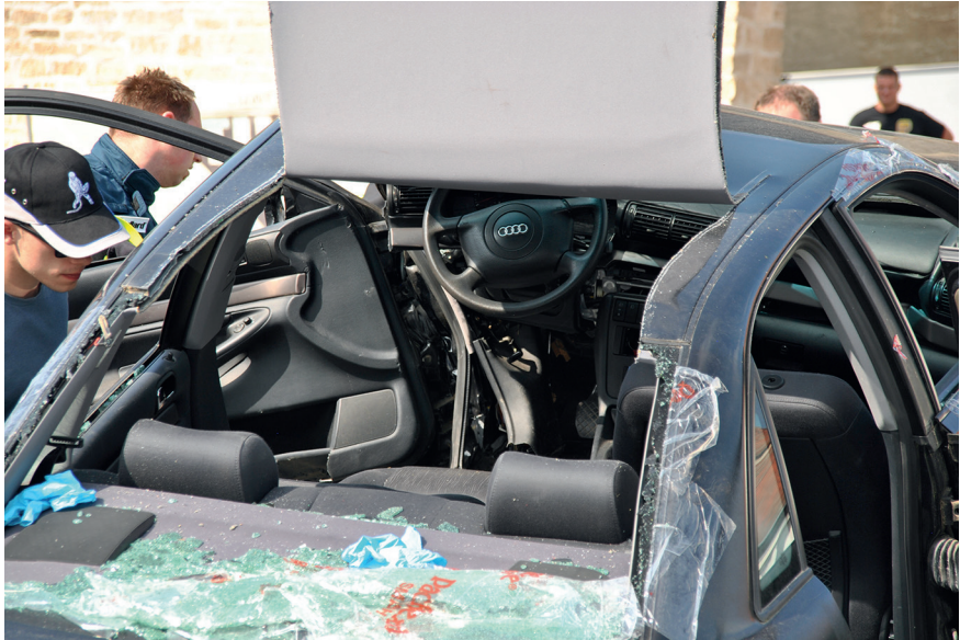
Abb. 51: Fischdose nach einer Übung. Die Airbagelemente sind in den (Dach-)Holmen verbaut, diese werden bei dieser Schnitttechnik umgangen.
