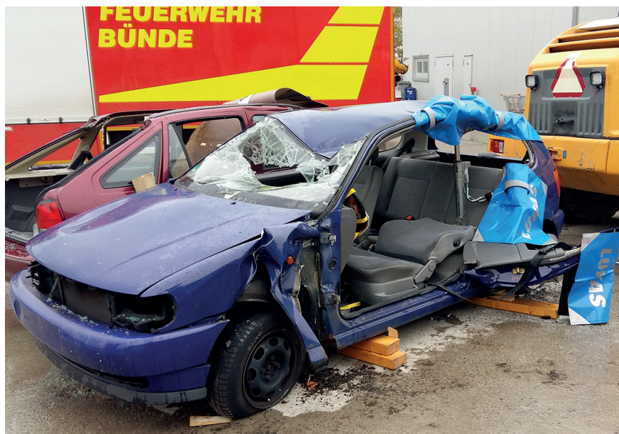
Abb. 49: Die dritte Tür ist die Seitenöffnung bei einem 2/3-Türer und zeichnet sich ebenfalls durch die Entfernung der B-Säule aus.
