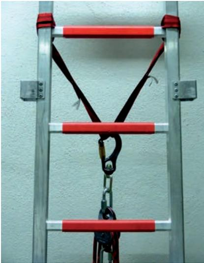
**Abbildung 29:** Anschlag der Leiterholme mit Bandschlingen mittels Ankerstich
