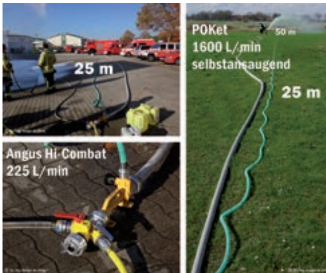
Abbildung 46a bis c: Versorgung von Zumischern und einem selbstansaugenden Werfer mit 25 und 50 m Spiralschlauch
