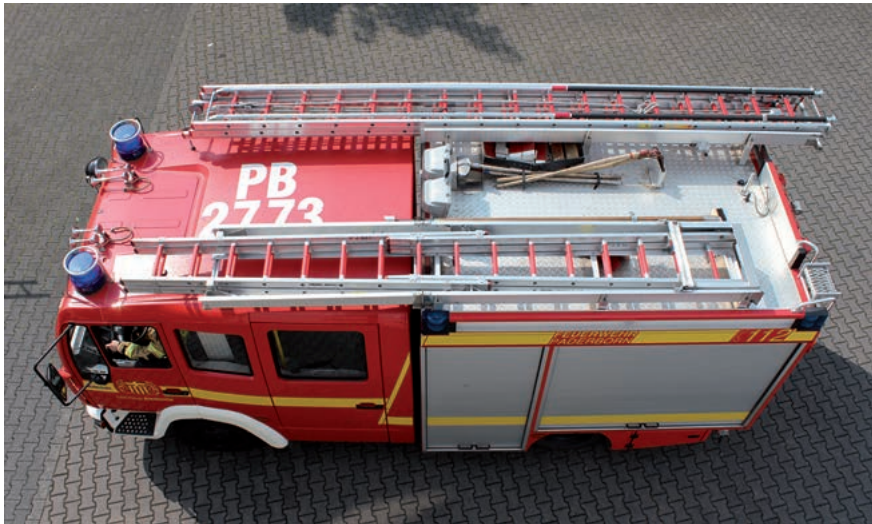
Abbildung 3: Lagerung tragbarer Leitern auf dem Fahrzeugdach (Quelle: Kemper)
