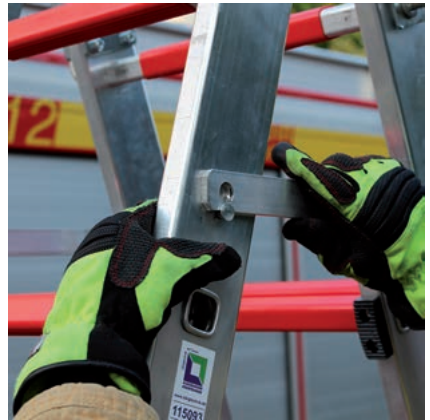
Abbildung 44: Einlegen der Klappstrebe (Quelle: Kemper)
