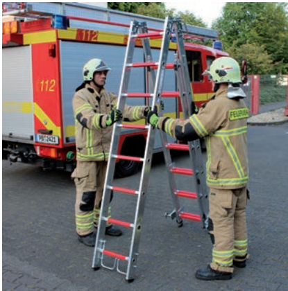
Abbildung 43: Aufklappen der Multifunktionsleiter (Quelle: Kemper)
