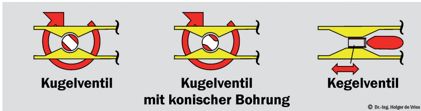
Abbildung 14: Ausführung von Absperrorganen in halb geöffneter Stellung
