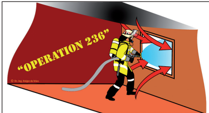
Abbildung 74: Behelfsmäßige Entrauchung mittels Hohlstrahlrohr – „Operation 236“ (Quelle: Jürgen Mayer, rechts)
