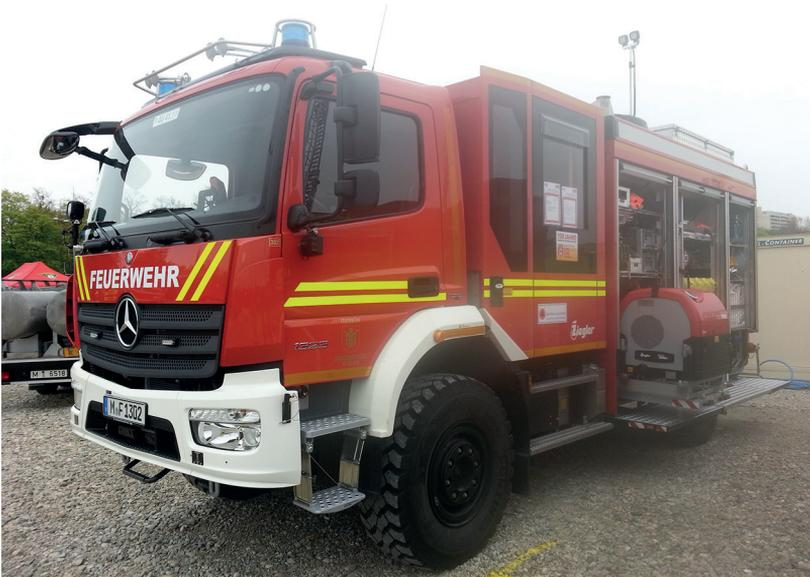
Abb. 45: LF-KatS mit leistungsstarker FPN und PFPN, 1000 l Löschwassertank, 600 m B-Druckschläuchen und Pressluftatmer in der Gruppenkabine auf einem Fahrgestell mit erhöhten Anforderungen an die Mobilität abseits befestigter Wege
