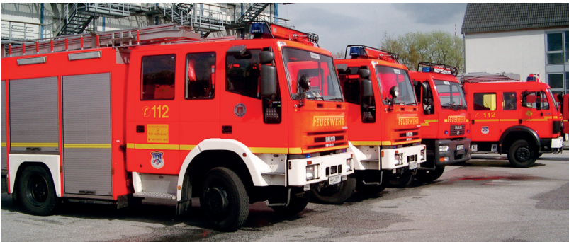
Abb. 46: Trotz unterschiedlicher Fahrgestelle und Aufbauten ist der taktische Wert der Fahrzeuge identisch. Man beachte die Hakenleiter auf der Seite, die nicht mehr Norm-Bestandteil der Ausrüstung ist.
