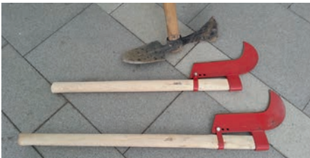
Abb. 6.2/9: Der Stiel einer Buschhacke (Brush-Hook) sollte ähnlich einem Axtstiel ausgeführt und darf nicht zu kurz sein. Er darf auch ergonomisch geschwungen sein (oberer Stiel ist zu kurz). Gedacht und geeignet sind diese Werkzeuge zum Entasten und Entrinden bzw. Rücken 2 (daher auch die „Hakennase“). Die Wiedehopfhacke gibt es mit gerader und gerundeter Klauenseite. Rund zum Graben bzw. Hacken vor allem für harte eher steinige Böden, gerade für weiche und saftige (Wiesen-)Böden sowie zum Trennen von Wurzeln. Für den Einsatz in der Vegetationsbrandbekämpfung in Deutschland ist daher i.d.R. die runde Klaue universeller geeignet. (Foto: Zawadke)
