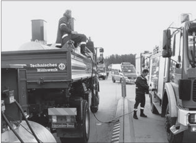
Bild 30: Mobile Tankstelle vom THW „stationär“ aufgebaut. D. h., die Tankstelle fährt nicht zu den Einheiten, sondern die Einheiten kommen zu einem festgelegten Betankungs- bzw. Versorgungspunkt. Tankmöglichkeiten auf beiden Seiten ermöglichen das Betanken in einer Fahrtrichtung unabhängig von der Lage des Tankstutzens! (Foto: Dr. Bräutigam, Düsseldorf)
