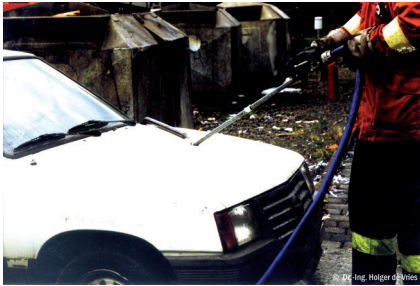
Abb. 3.4.1.3/4a und b: Löschanze aus industrieüblichen Komponenten (Fotos: de Vries)
