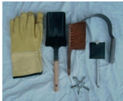
Abb. 5.2.1/1: Gerätschaften für die untere Schornsteinreinigung, hier noch ergänzt durch einen Handfeger. (Foto: Wendel)
