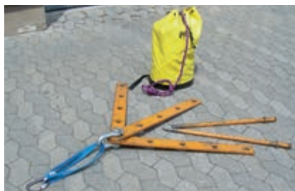
Abb. 4.3.5.1/11: Erdanker des Mehrweckzuges als Anschlagpunkt (Foto: Werft)
