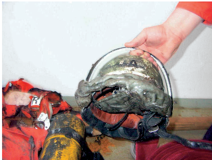
Abb. 5.1.3.2/2: Zerstörter Feuerwehr- helm mit Gesichtsschutz
