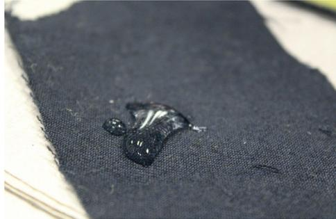
**Abb. 4 & 5:** Durchdringungsverhalten der Membran (links) und Obermaterial (rechts) einer HuPF-Überjacke (Quelle: Verfasser)
