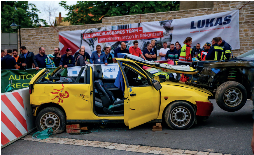
Abb. 50: Nach vorne geklapptes Dach, die A-Säule bleibt ungeschnitten: Glassplitter und Staub werden vermieden.
