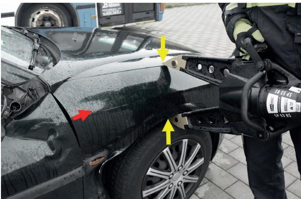
**Abb. 10:** Zusammendrücken des Kotflügels mit dem Spreizer. Durch die Verformung öffnet sich der Spalt zwischen Kotflügel und Tür. (Quelle: Verfasser)
