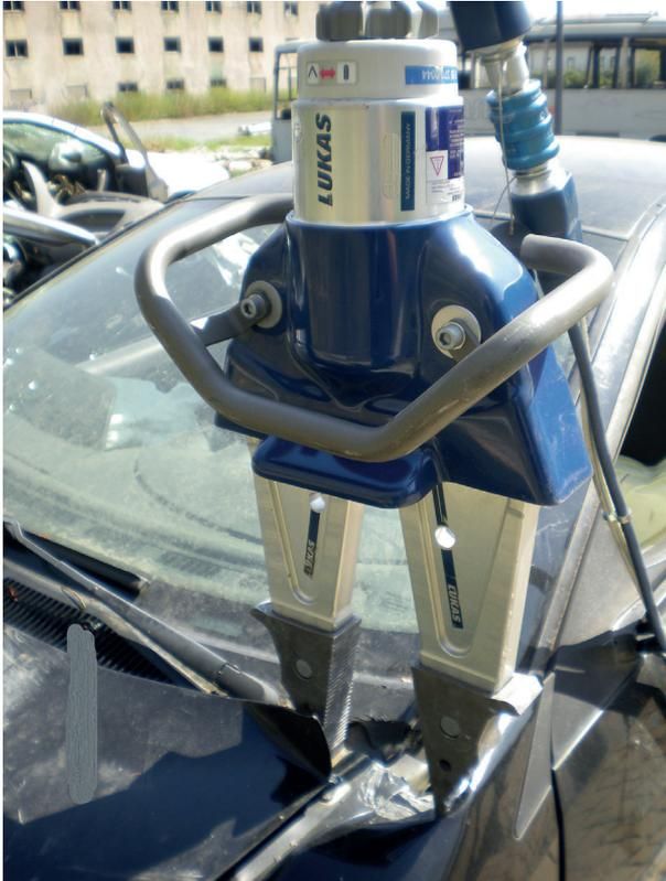
Mit dem Ansetzen des Spreizers an dem vorhandenen Spalt zwischen der Motorhaube und der Windschutzscheibe kann das Material des Kotflügels verschoben werden. Dadurch kann einerseits der Spalt zwischen Kotflügel und vorderer Tür vergrößert werden, um den Spreizer ansetzen zu können. Zusätzlich dient diese Option als erster Schritt den Bereich freizulegen und das Material des Kotflügels gänzlich zu entfernen.
