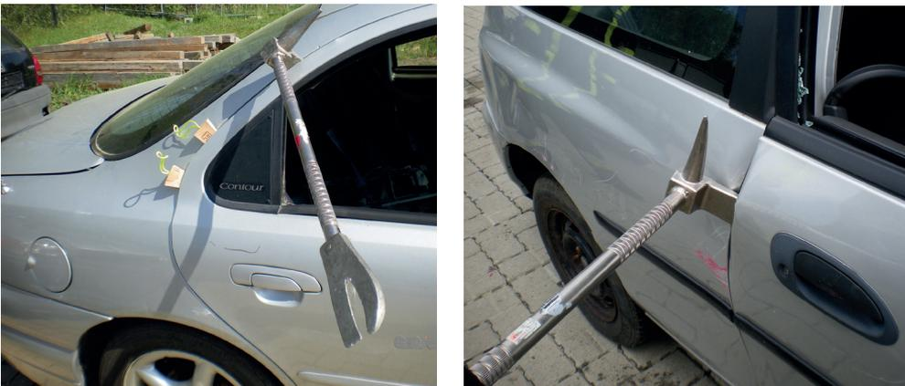
**Abb. 4 & 5:** Schaffen eines Ansatzpunktes durch Hebeln mit der flachen Kopfseite des Werkzeuges in dem oberen Bereich des Türrahmens und Offenhalten des Spaltes mit Keilen (links). Je näher am Schloss gehebelt wird, desto größer ist der Widerstand. Um schnell einen Ansatzpunkt zu schaffen, sollte Abstand zu dem Schloss gehalten werden. (Quelle: Verfasser)
