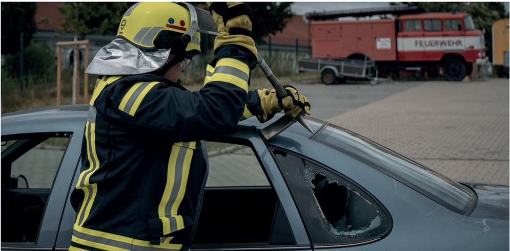
**Abb. 1:** Ansatzpunkte können sowohl mit Handwerkzeug als auch mit hydraulischem Rettungsgerät geschaffen werden. Wichtig ist, dass die Einsatzkräfte in den Handfertigkeiten ausgebildet und trainiert sind. (Quelle: Lukas Endner)
