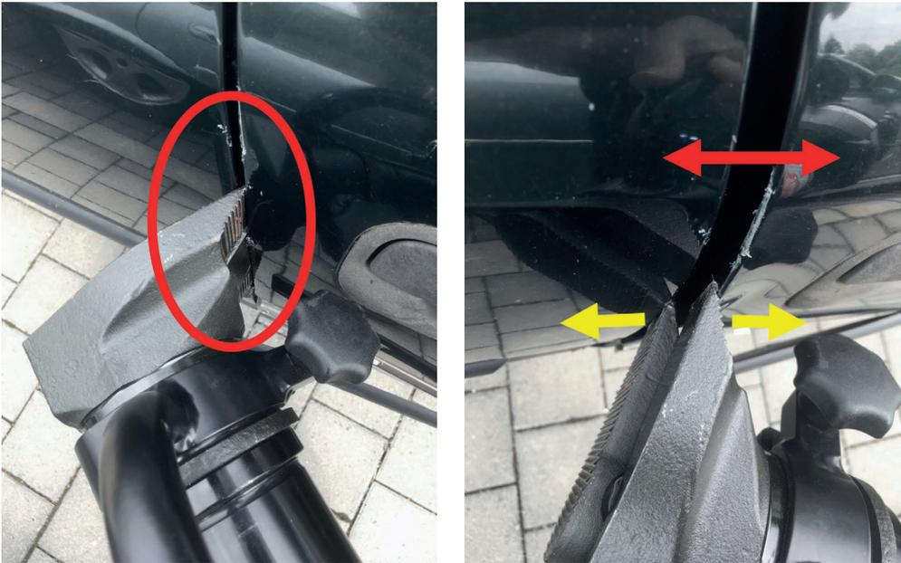
**Abb. 13 & 14:** Einsatz eines akkubetriebenen, hydraulischen Türöffners, um das Spaltmaß zu vergrößern und einen Ansatzpunkt für den Spreizer zu schaffen (Quelle: Verfasser)
