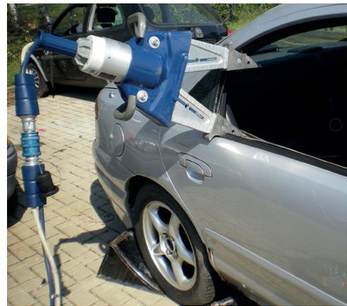
**Abb. 6 & 7:** Das Ausfahren des in die Fensteröffnung eingesetzten Spreizers kann nach nur wenigen Zentimetern einen ausreichenden Ansatzpunkt an der Schlossseite erzeugen. Der Spreizer ist mit dem Handgriff nach oben anzusetzen, dass die Tür nach außen und nicht nach unten gedrückt wird. Die Maßnahme kann an vorderen (links) und hinteren (rechts) Türen durchgeführt werden. (Quelle: Verfasser)
