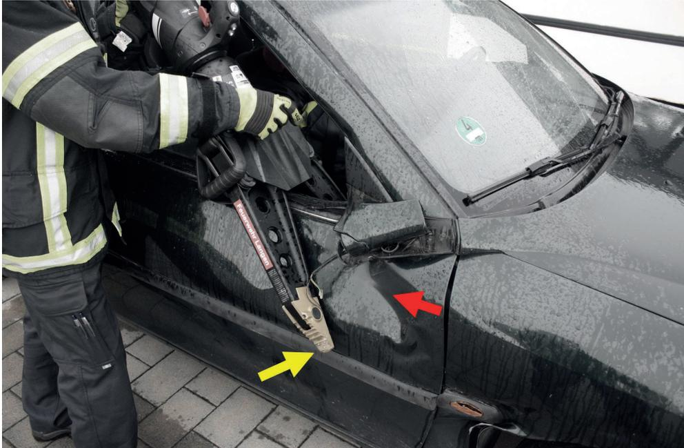
**Abb. 12:** Das Zusammendrücken der Tür kann die Spaltmaße vergrößern, um einen Ansatzpunkt für den geschlossenen Spreizer zu erzeugen. (Quelle: Verfasser)
