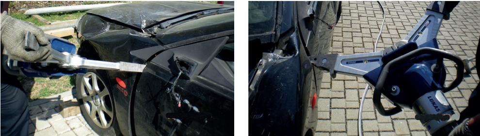
**Abb. 8 & 9:** Einsetzen einer Spreizerspitze und Drehbewegung, um aus dem Spalt einen Ansatzpunkt zu machen (Quelle: Verfasser)
