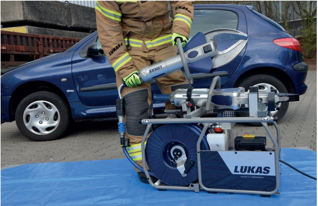
Abb. 1: Rettungsschere (Quelle: LUKAS Hydraulik GmbH)
