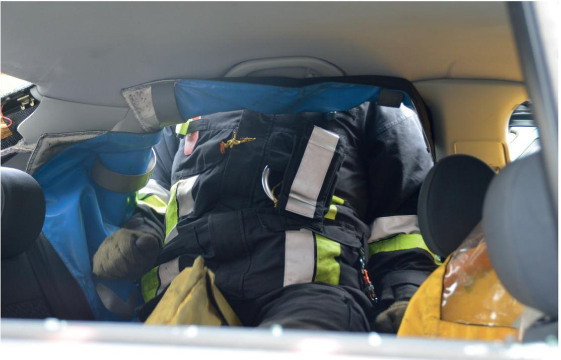
Abb. 66: Zugang des Inneren Retters über kleine Scheibe mit Kantenschutz
