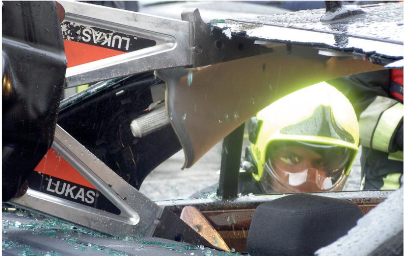
Abb. 65: Hybridgaszylinder
