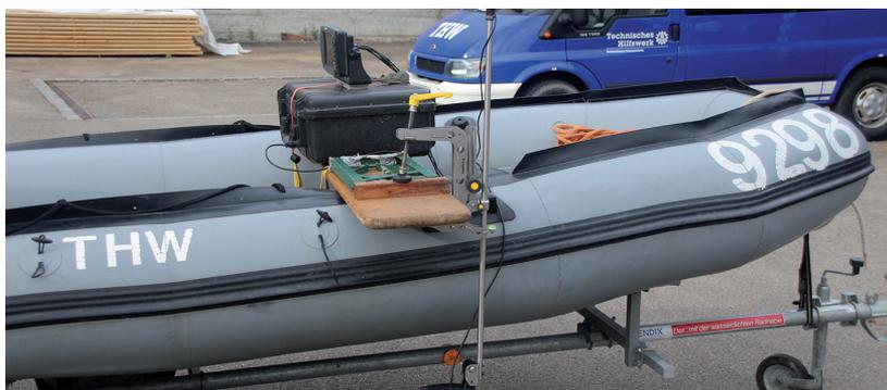
Abb. 80: Behelfsmäßig installiertes Sonarsystem (Foto: Kiener, Donauwörth)
