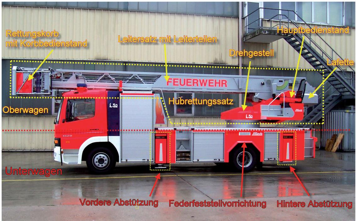
Abb. 11: Baugruppen einer Drehleiter am Beispiel einer METZ-Drehleiter.
