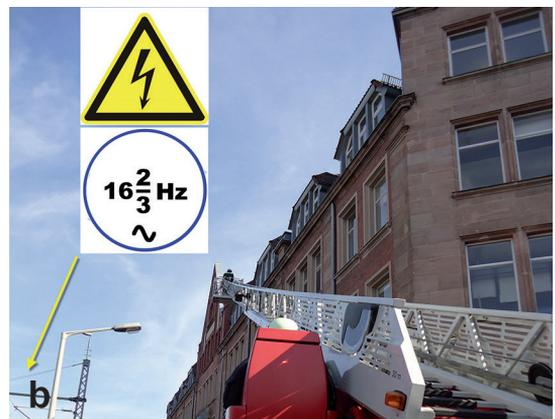
Abb. 42a und b: Drehleitereinsatz im Bereich von Oberleitungen bzw. Speiseleitungen der Eisenbahn.
