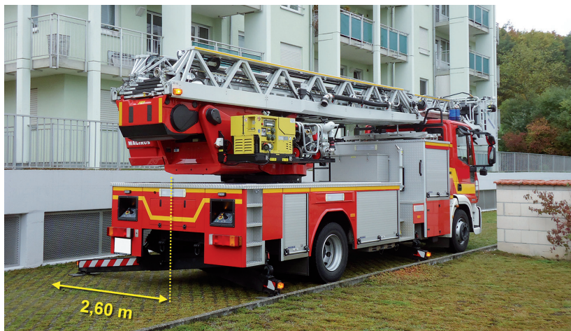
Abb. 140: Erforderlicher Mindestabstand zwischen Drehkranzmitte (= Fahrzeugmitte in Längsachse) und nächstliegendem Hindernis im Bereich der Abstützungen auf der dem Einsatzobjekt hin zugekehrten Fahrzeugseite.
