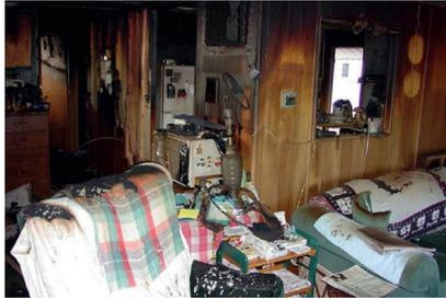
Abb. 7: Brandraum mit intensiver thermischer Aufbereitung ohne flammende Verbrennung; die angekohhten Gegenstände haben massiv Pyrolysegase freigesetzt, die sich jedoch aufgrund unzureichenden Sauerstoffangebots nicht entzündeten (Foto: Gresham, Fire & Emergency Services)
