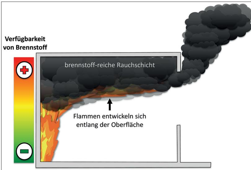
Abb. 20: Querschnitt durch einen Raum bei Rauchdurchzündung mit Verteilung des Brennstoffes im Raum (Grafik: Weich, Düsseldorf; nach BENGTTSSON)
