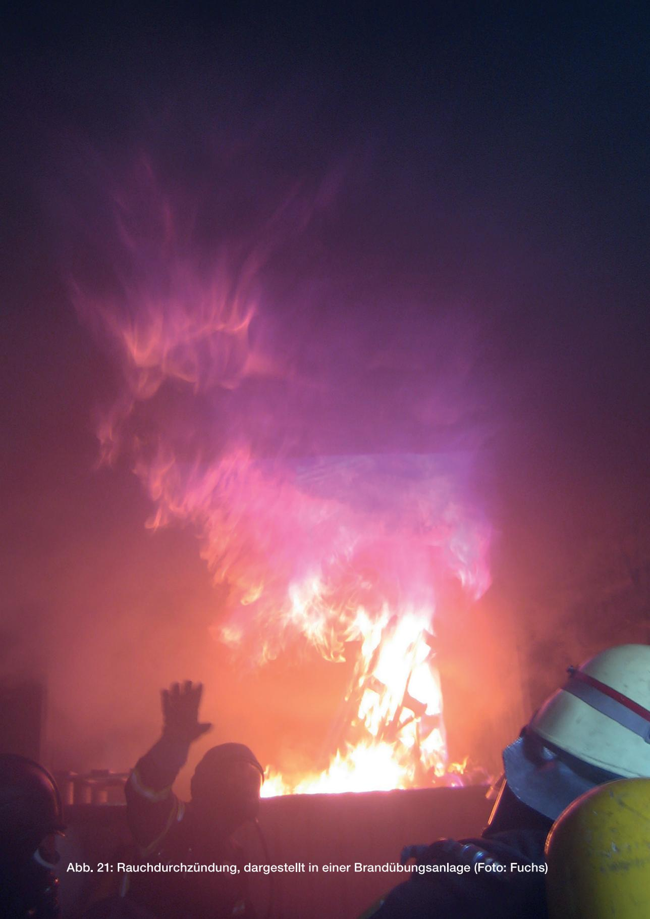
Abb. 21: Rauchdurchzündung, dargestellt in einer Brandübungsanlage (Foto: Fuchs)
